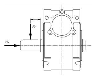
В данной таблице дана величина допустимой радиальной консольной нагрузки Fr [H], приложенной в середине выходного вала. Допускается также приложение осевой нагрузки, равной:
