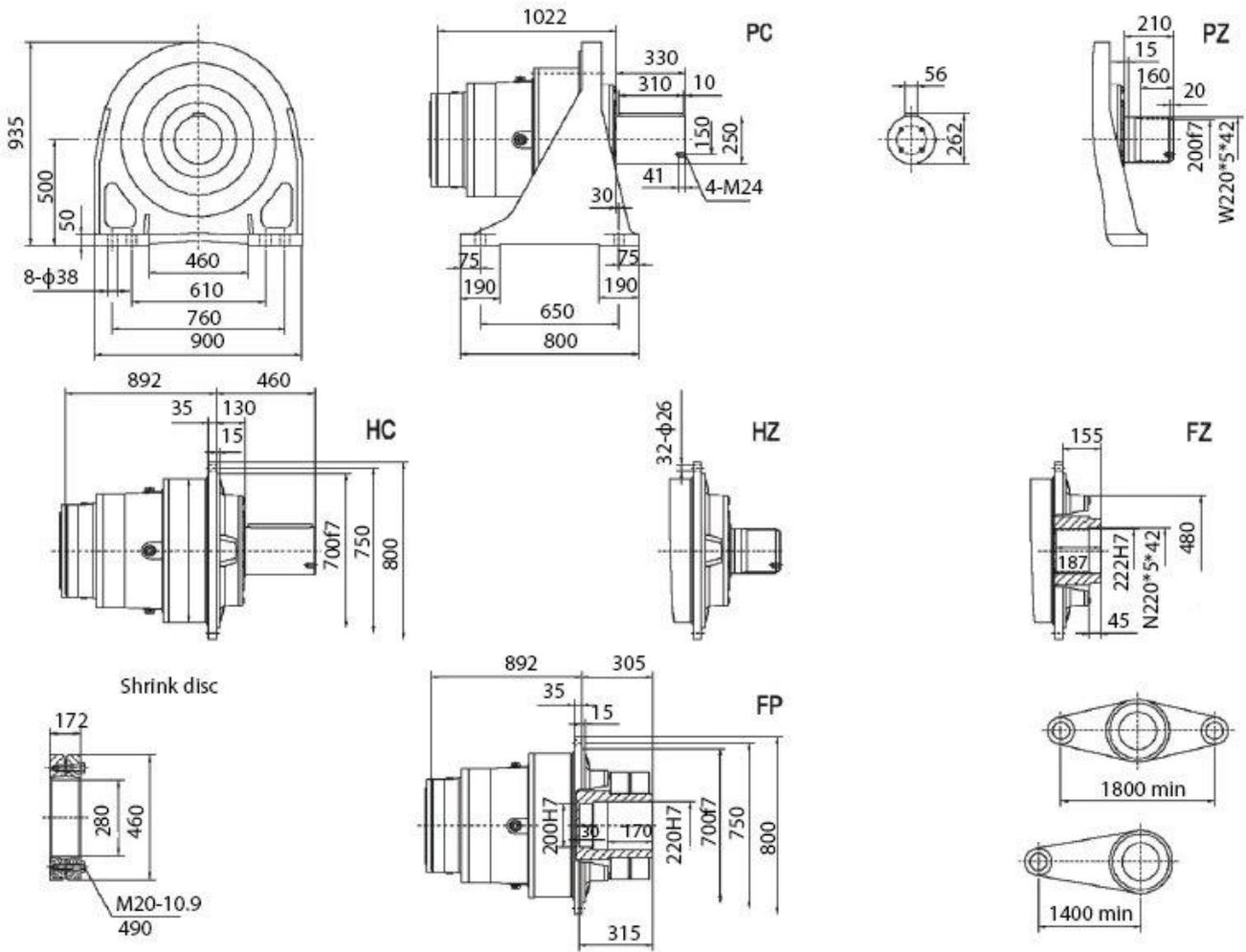
Четырехступенчатый угловой мотор-редуктор SPN18 R4(B)
