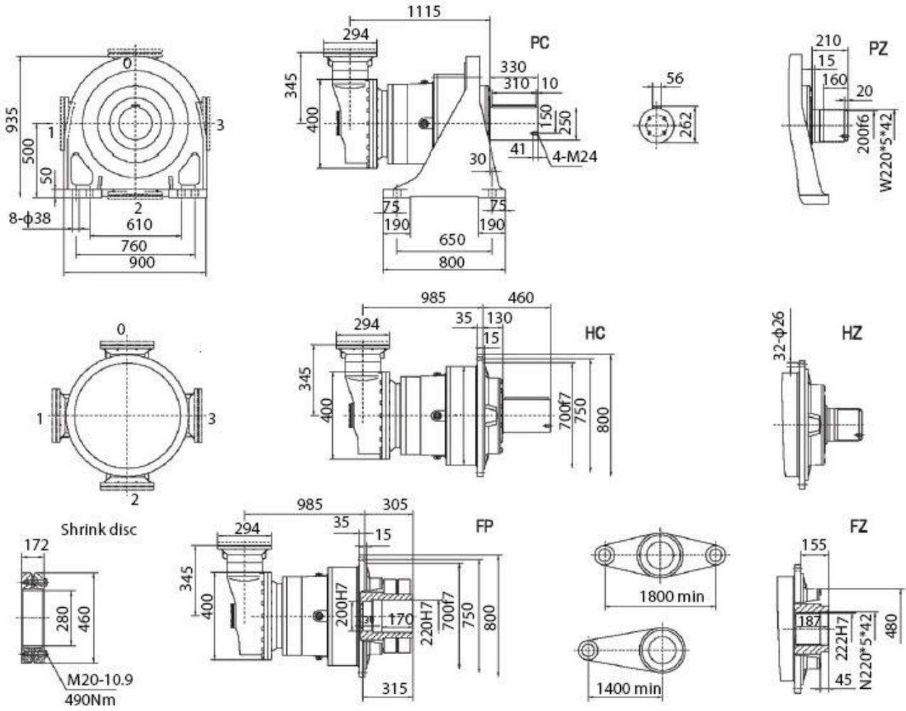
Четырехступенчатый угловой мотор-редуктор SPN18 R4(C)
