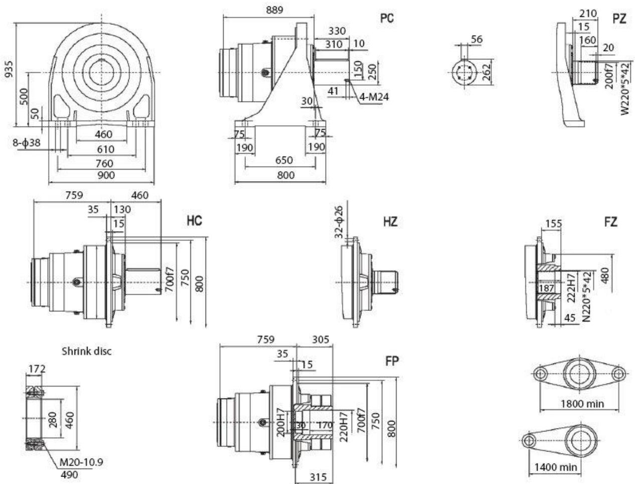
Четырехступенчатый соосный мотор-редуктор SPN18 L4
