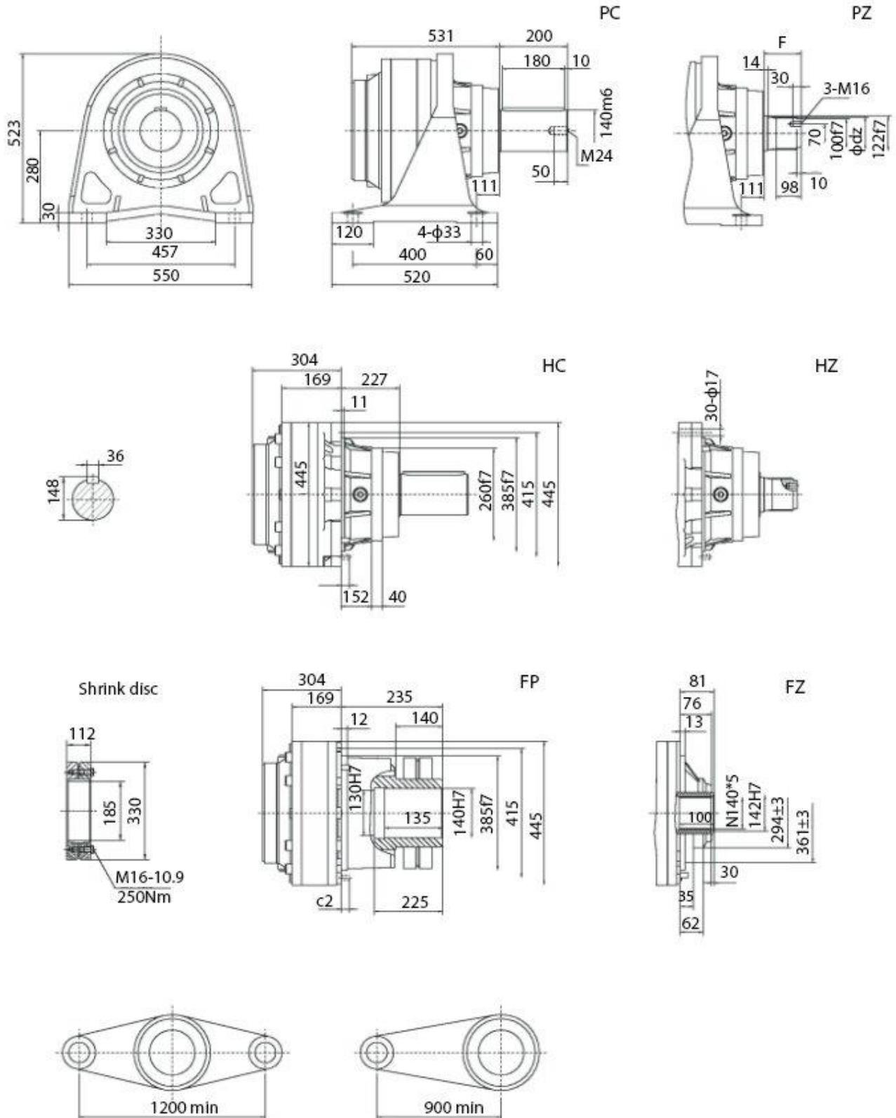
Трехступенчатый соосный мотор-редуктор SPN13 L3
