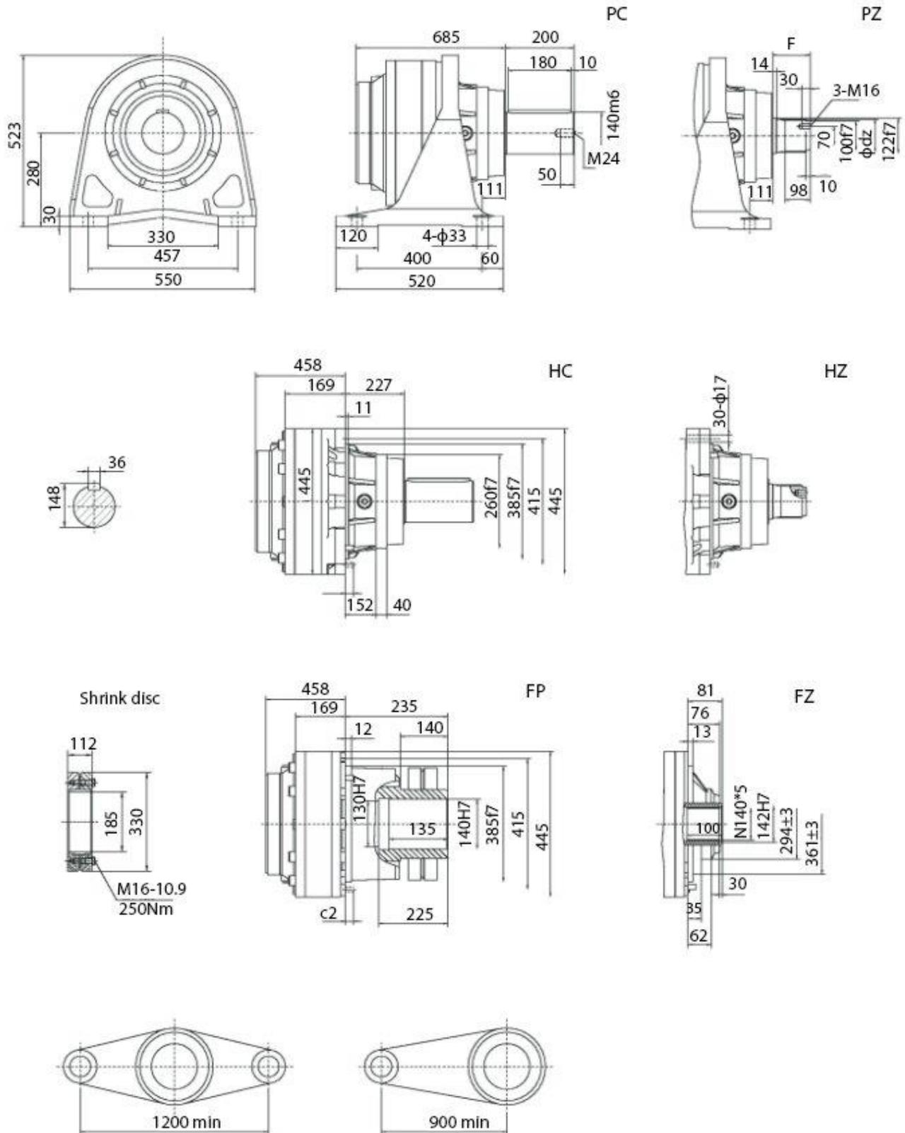
Двухступенчатый угловой мотор-редуктор SPN13 R2(B)
