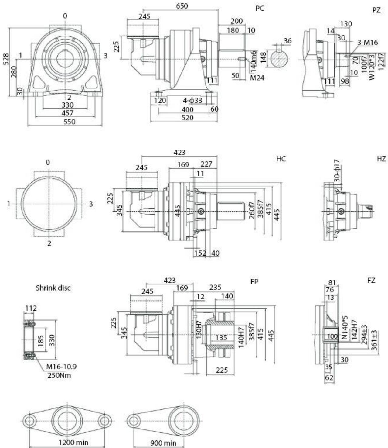
Четырехступенчатый угловой мотор-редуктор SPN13 R4
