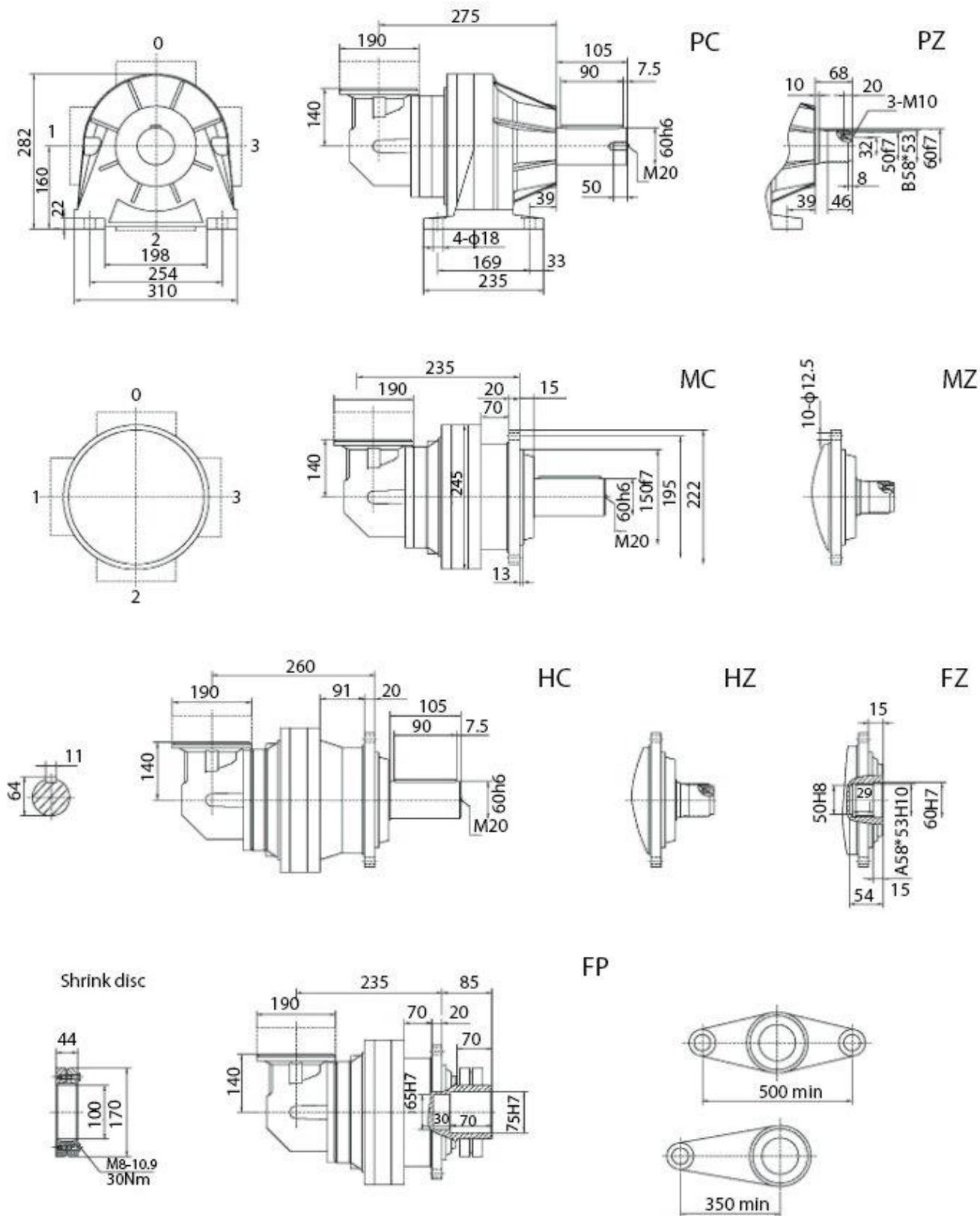
Трехступенчатый угловой мотор-редуктор SPN05 R3
