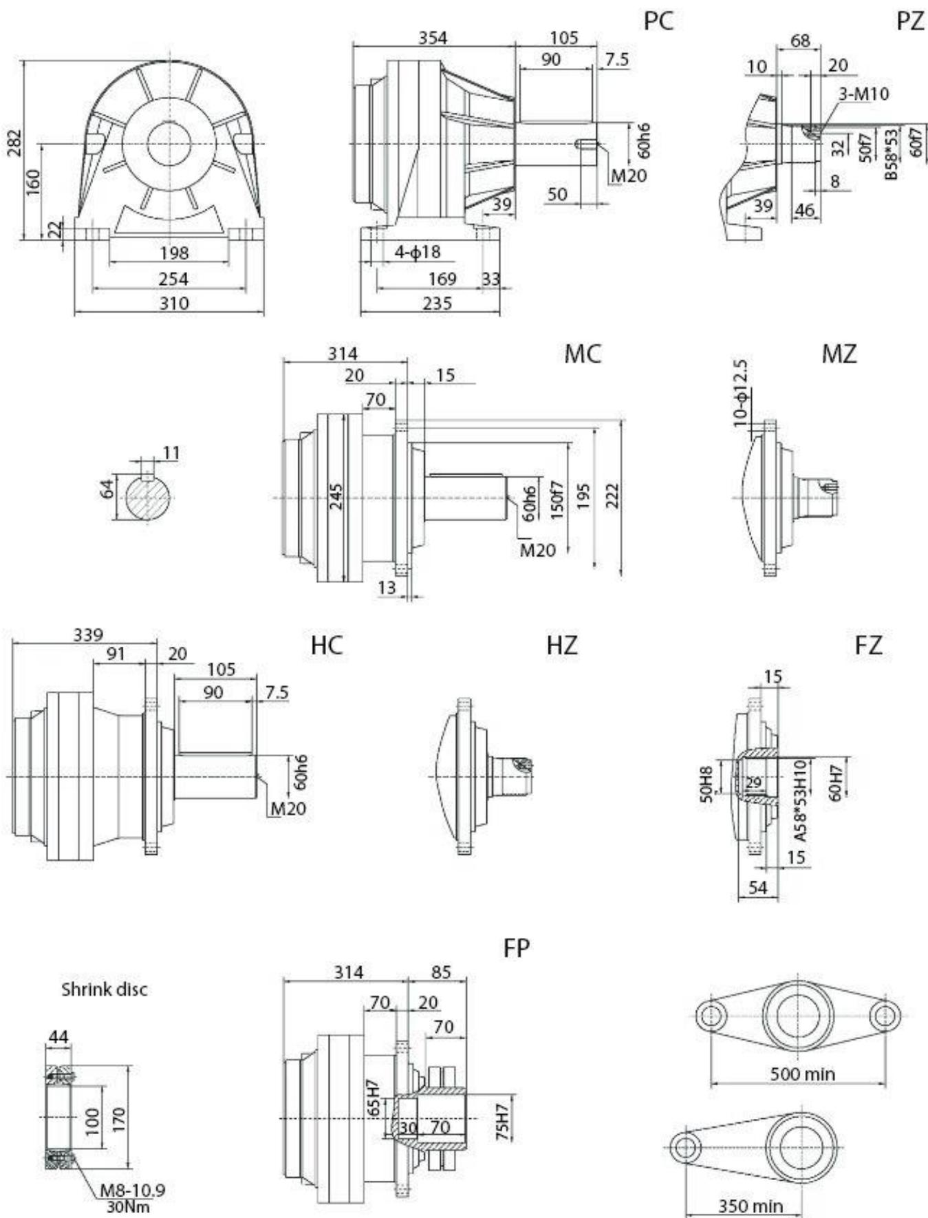
Двухступенчатый угловой мотор-редуктор SPN05 R2
