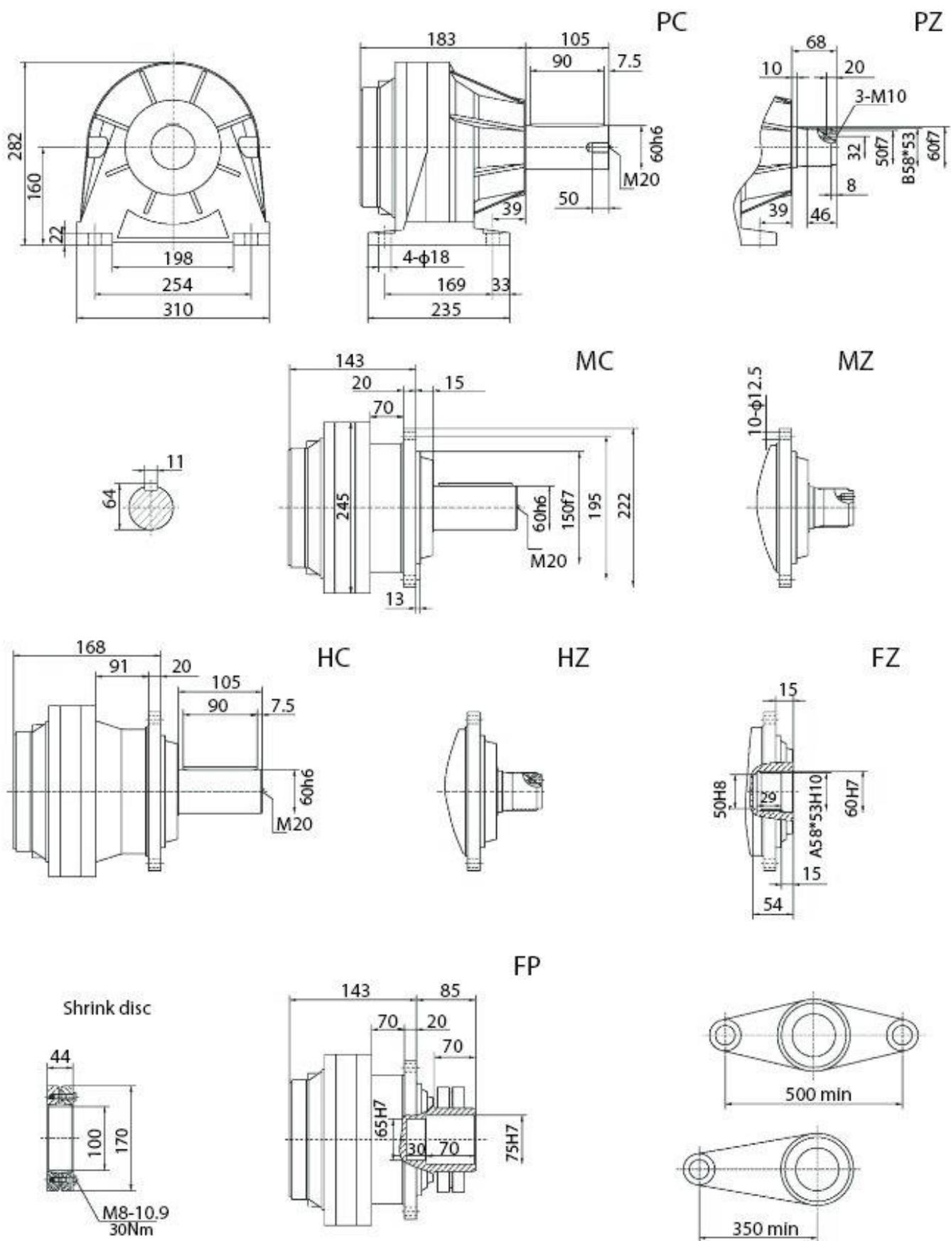
Двухступенчатый соосный мотор-редуктор SPN05 L2
