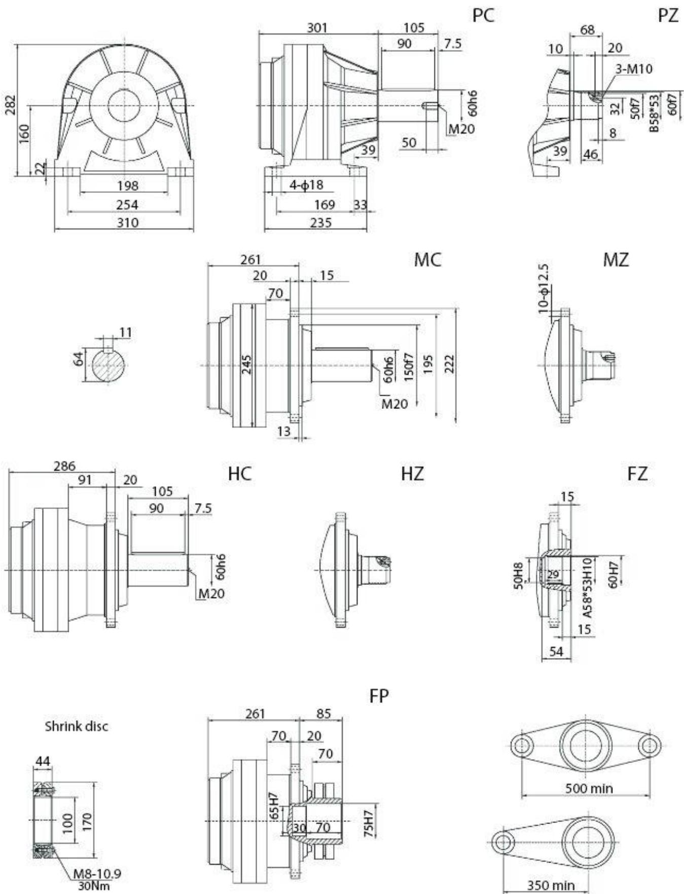
Четырехступенчатый соосный мотор-редуктор SPN05 L4
