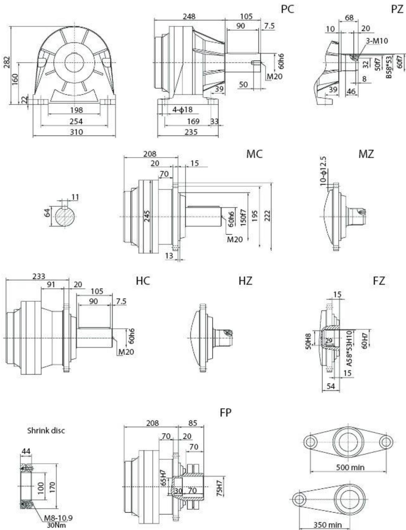
Трехступенчатый соосный мотор-редуктор SPN05 L3
