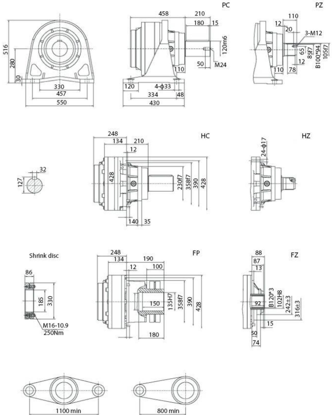
Трехступенчатый соосный мотор-редуктор SPN11 L3
