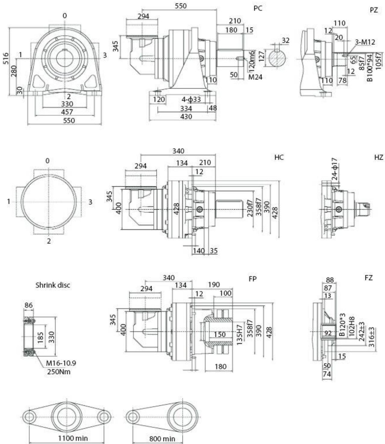
Двухступенчатый угловой мотор-редуктор SPN11 R2(C)
