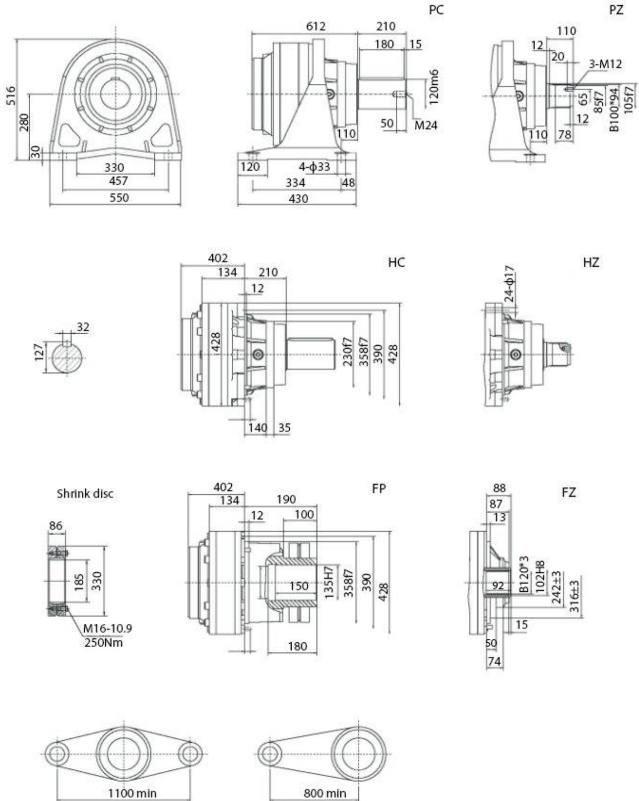
Двухступенчатый угловой мотор-редуктор SPN11 R2(B)
