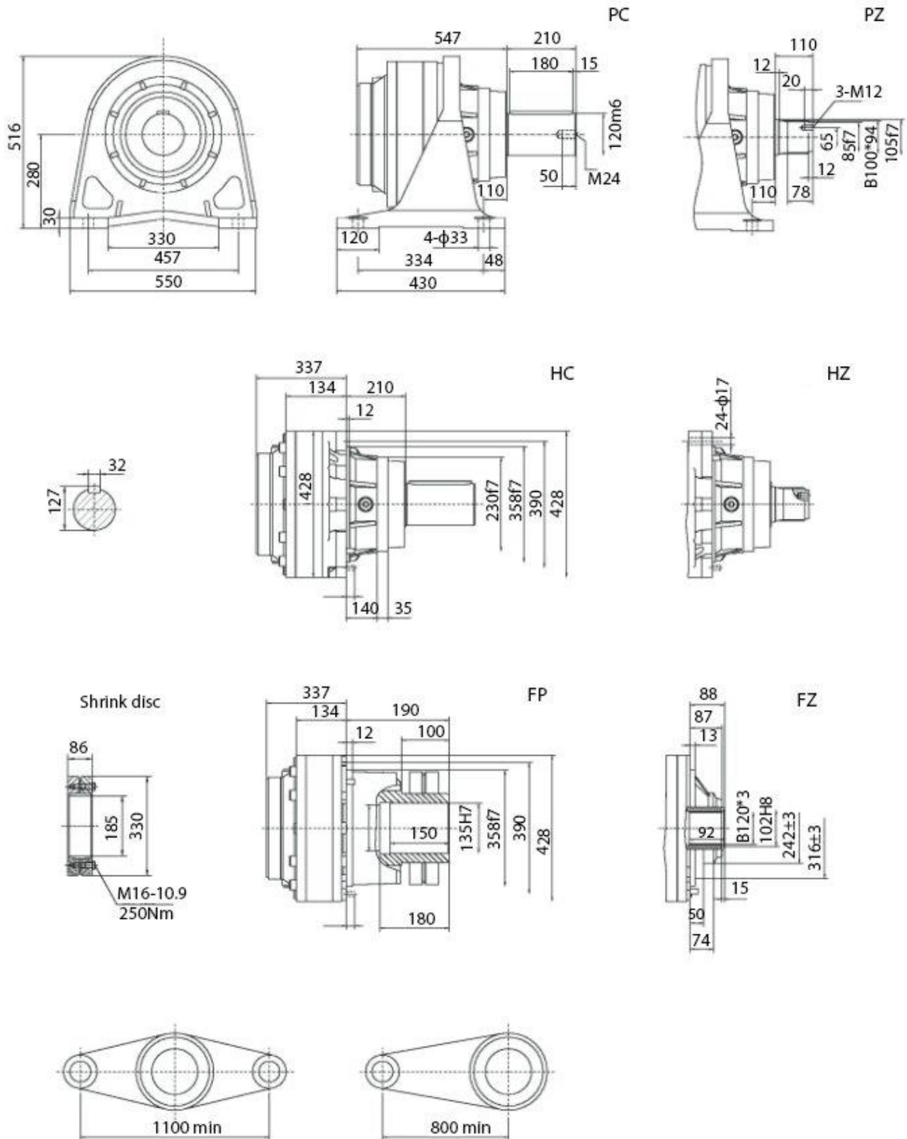
Четырехступенчатый соосный мотор-редуктор SPN11 L4
