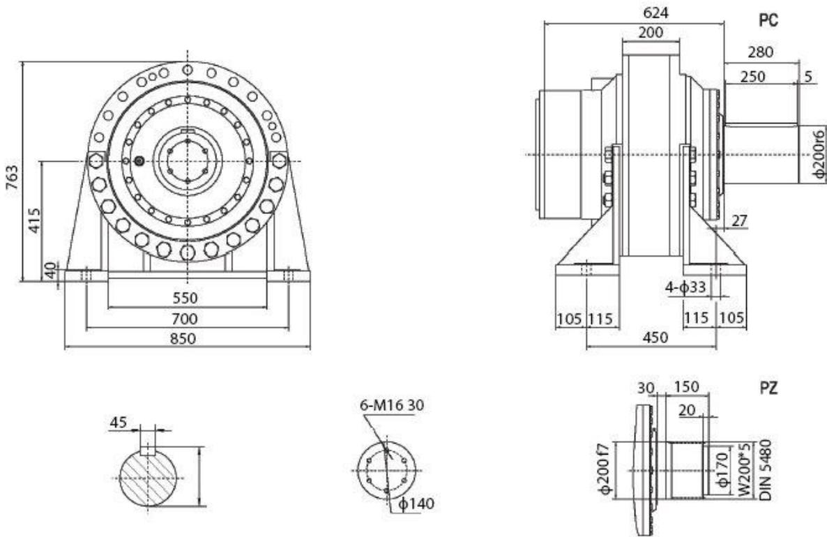
Трехступенчатый соосный мотор-редуктор SPN17 L3
